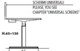
BENCH CON ALTEZZA REGOLABILE H.65+130 (con sistema motorizzato)
