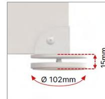
Piedino in metallo con livellatore in ABS metallizzato effetto cromo, Ø102mm, regolazione 0-15mm.
