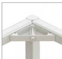
Traversi e longoni a sezione quadrata 30×30mm, sp. 2 mm. Giunto in zama, fissaggio con una sola vite.
