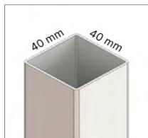
Gamba 01 in tubo di acciaio sezione 40×40 sp. 1,5 mm con staffe laterali in lamiera piegata di acciaio sp. 3 mm.
