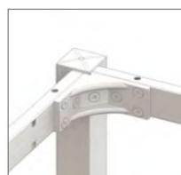
Traversi e longoni a sezione rettangolare 50×20 mm, sp. 1,5 mm, collegati con staffe angolari in pressofusione di alluminio, dim. 100×100 x h 50mm.
