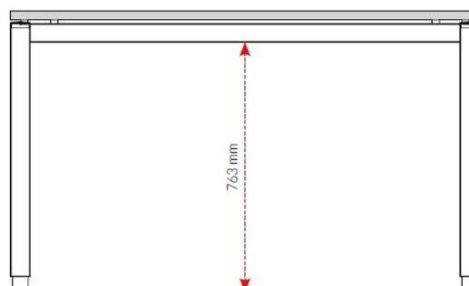
Distanza massima pavimento-longone con gamba metallica regolabile opzionale
