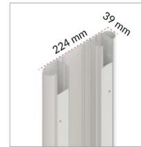
Gamba metallica con montante verticale in lamiera piegata di acciaio sp. 1 mm, a sezione 110x21 mm e carter sp. 1,3 a sezione 224x39 mm.
