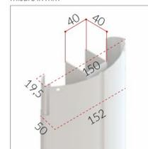
Gamba metallica con montante in tubo di acciaio sezione 40x40 sp. 1,5 mm e in lamiera piegata sp. 1 mm, sezione 150x19,5 mm.
