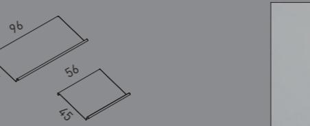
I→Ripiani/espositori inclinati in acciaio microforato verniciato con polveri epossidiche finitura nero o grigio metallizzato. GB→Ripiani/espositori inclinati in acciaio pieno o microforato verniciato con polveri epossidiche finitura nero o grigio metallizzato.
